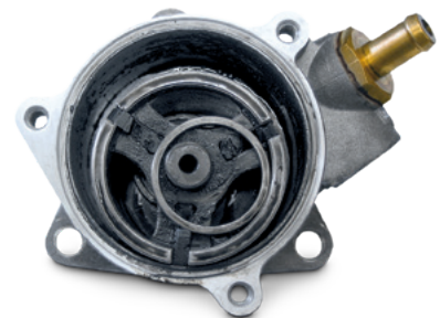
Schmierölmangel durch verunreinigtes, überaltertes Motoröl.
